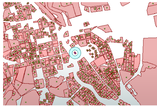
(b). Buffercirkelsegment med inre radie 50 meter och yttre radie 100 meter.
