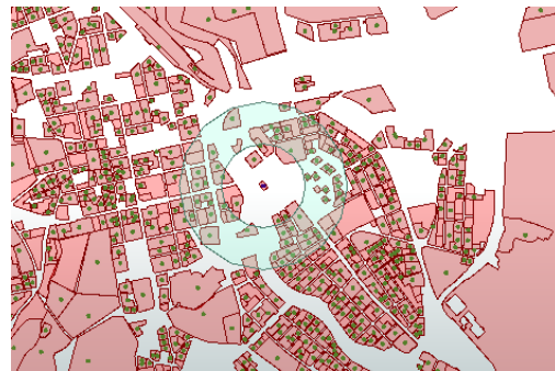
(d). Buffercirkelsegment med inre radie 200 meter och yttre radie 400 meter.
