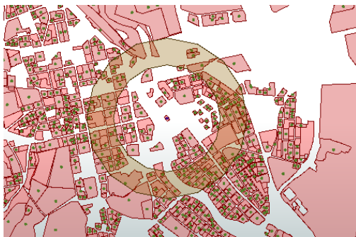
(e). Buffercirkelsegment med inre radie 400 meter och yttre radie 600 meter.
