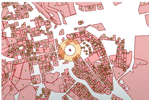
(c). Buffercirkelsegment med inre radie 100 meter och yttre radie 200 meter.
