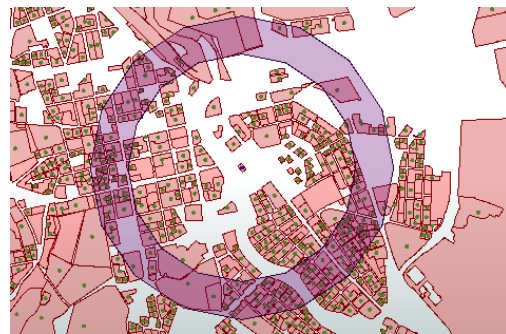
(f). Buffercirkelsegment med inre radie 600 meter och yttre radie 800 meter.
