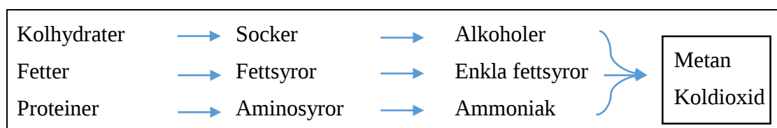
Figur 2. Anaerob nedbrytning av organiskt material (efter Svenskt Vatten, 2010).
