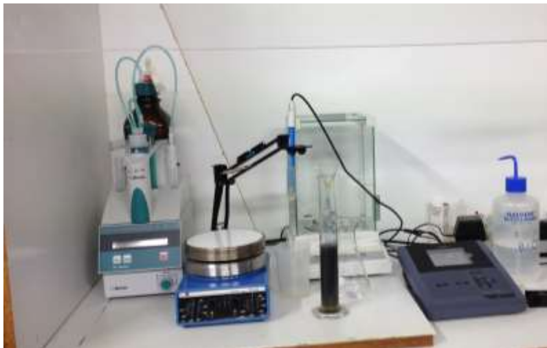
Figur 7. Laborarieutrustning för alkalinitetsmätning. Dosimat för titrering vid bestämning av alkalinitet (t.v.), magnetomrörare, mätglas med klarfas och pH-meter (t.h.).
