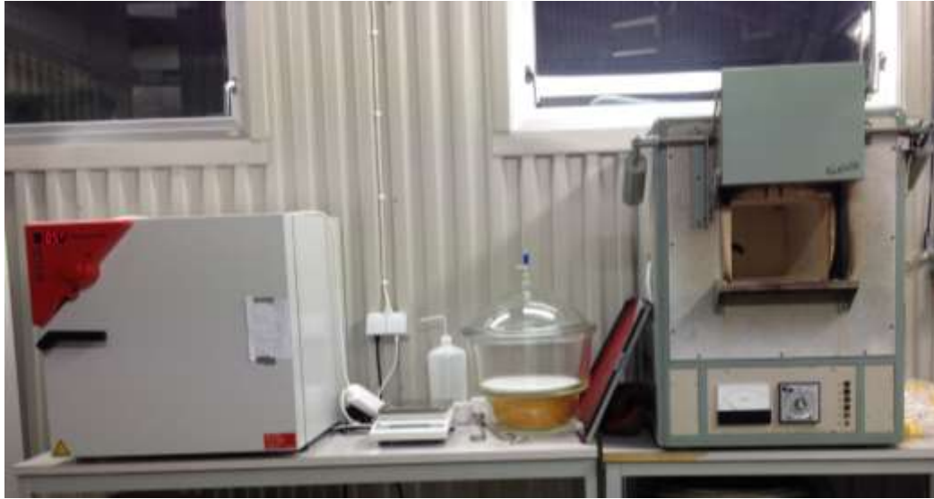
Figur 6. Utrustning för analys av TS och VS. Indunstningsugn (t.v.), våg, exsikator samt glödugn (t.h.).
