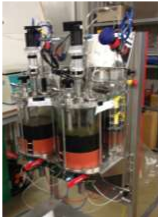
Figur 4. Rötkamrarna. Rötkammare 1 (t.v.) som användes som kontroll med enbart slam och rötkammare 2 (t.h.) med inblandning av 37 % (viktprocent baserat på VS-innehåll) mikroalger i slammet. Bluescens CH 4 -gassensorn ses högst upp till höger.
