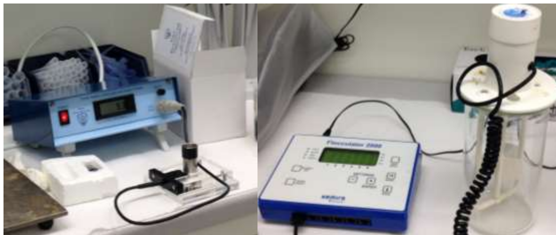
Figur 8. CST-mätaren med tillhörande cylinder (t.v.) och flocculatorn som användes vid omrörning (t.h).
