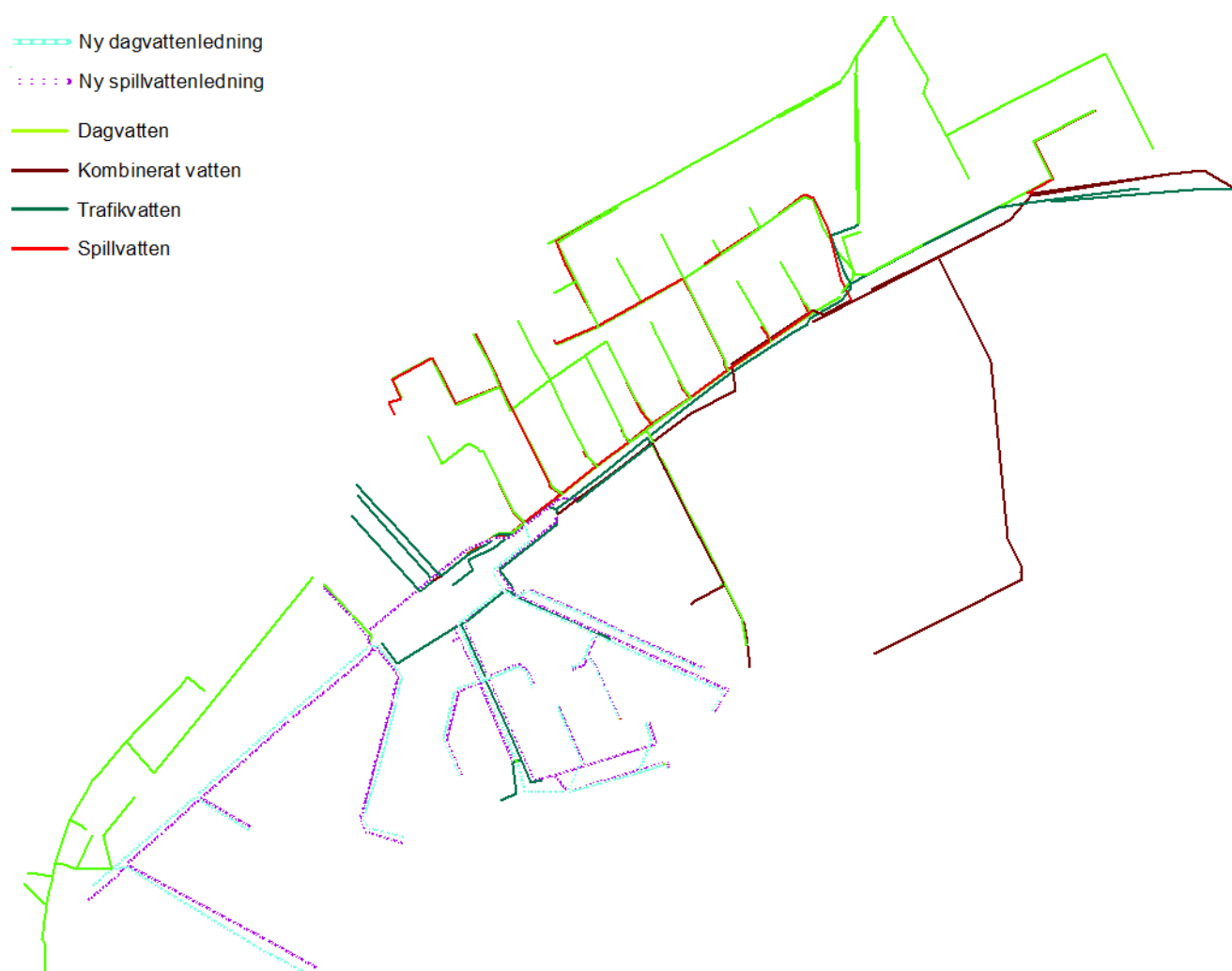
Figur 33: Separeing av Av1 väst mot Karlbergssjön och Av2 Av3 öst via L-magasinet mot Brunnsviken.
