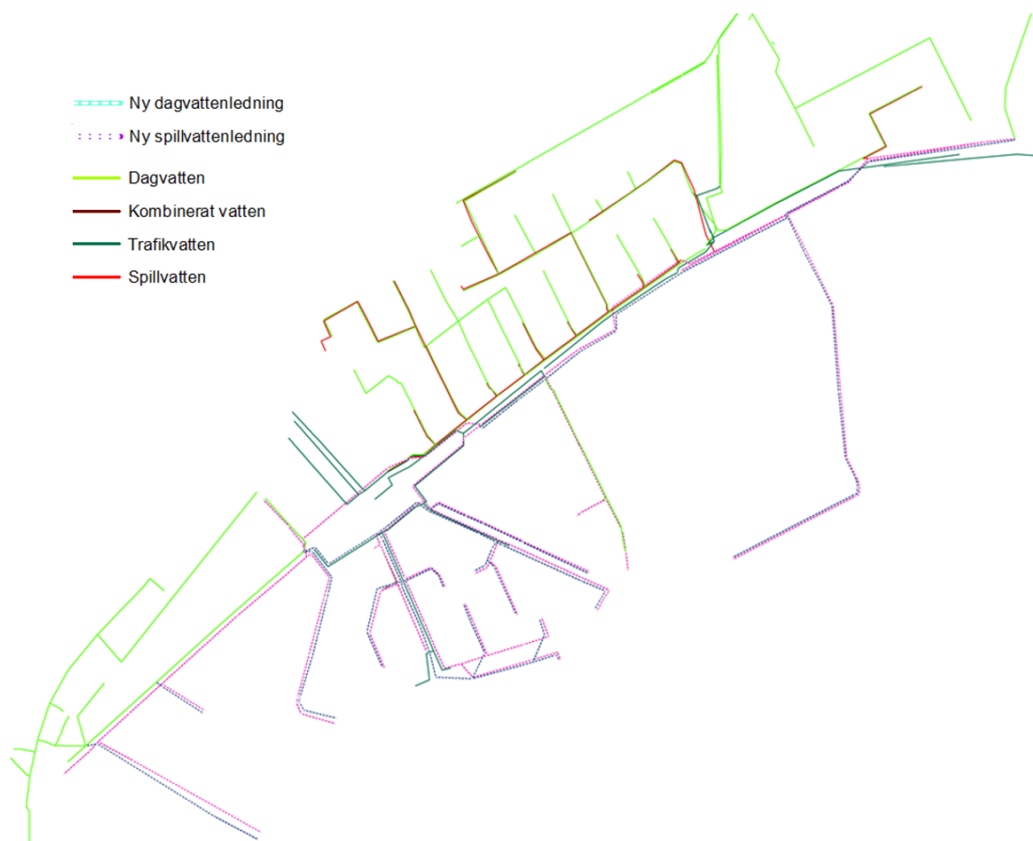
Figur 37: Separeing av Av1 Av2 Av3 väst mot Karlbergssjön och Av4 Av5 Nordöst via bräddavloppet för rörmagasin.
