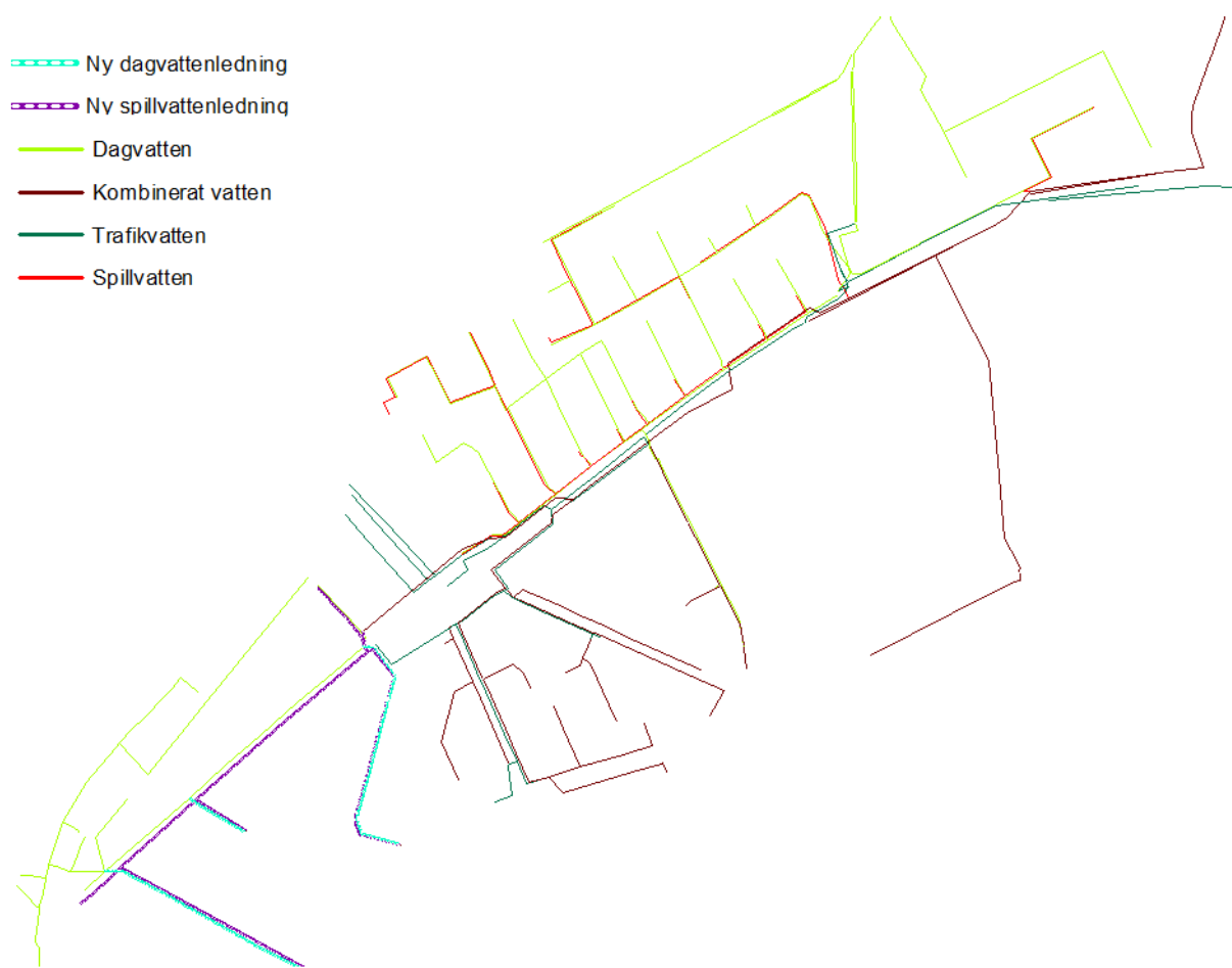
Figur 23: Separering av Av1 där det rena dagvattnet leds väst mot Karlbergssjön.
