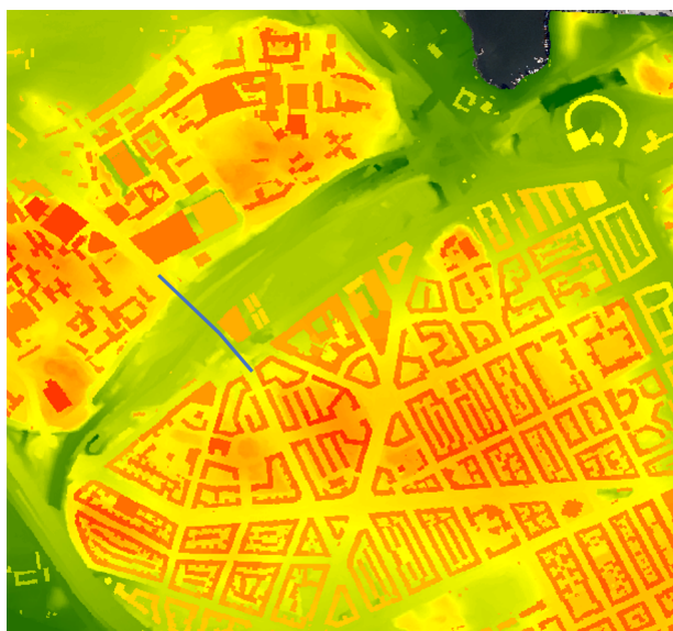
Figur 9: Topografin över det undersökta området där det röda representerar de högsta punkterna, de gröna lågpunkterna och den blå linjen visar vattendelaren (Mattisson & Karlsson 2018).
