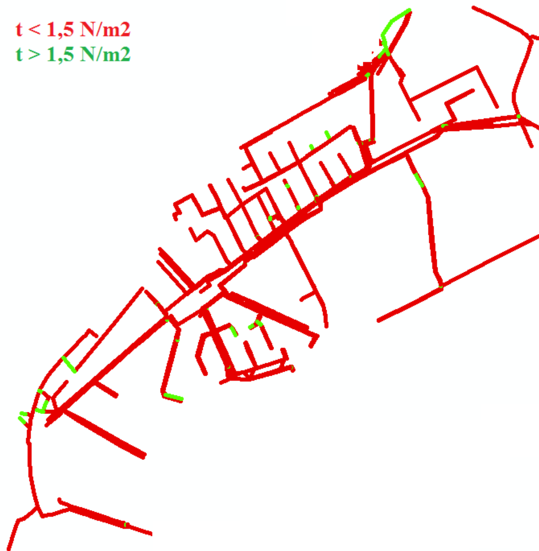
Figur 15: Förväntad skjuvspänning baserat på minimala flödet för ett 10-årsregn på ledningssystemet för den fullständiga separeringen. Det gröna representerar ett självrensandesystem medan det röda partierna inte uppnådde tillräckligt hög skjuvspänning.
