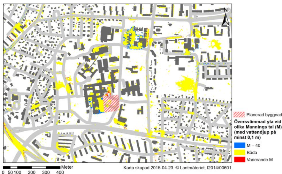
Figur 25. Översvämmad yta (minst 0,1 m) vid både varierande värden på M samt med ett konstant värde på 40. De områden som endast översvämmas vid varierande M respektive M = 40 finns också utmarkerade.
