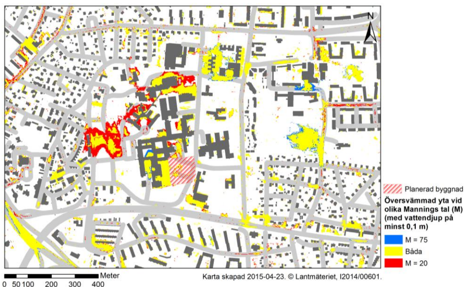
Figur 27. Översvämmad yta (minst 0,1 m) vid ett lågt respektive högt konstant värde på M (20 respektive 75). De områden som endast översvämmas vid M = 20 respektive M = 75 finns också utmarkerade.
