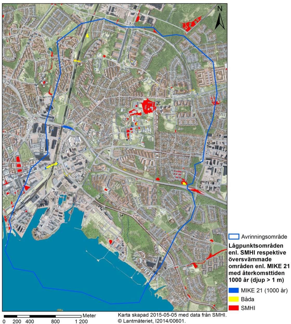
Figur 73. Jämförelse mellan SMHI:s karterade lågpunktsområden och de simulerade ytorna som översvämmas med ett djup på minst 1 m vid ett regn med återkomsttiden 1000 år. De ytor som både ligger i lågpunktsområden och som kommer översvämmas enligt simuleringarna från MIKE 21 visas också i figuren.
