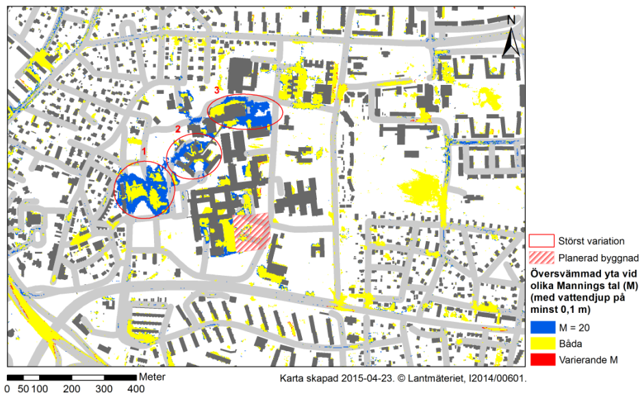
Figur 24. Översvämmad yta (minst 0,1 m) vid både varierande värden på M samt med ett konstant värde på 20. De områden som endast översvämmas vid varierande M respektive M = 20 finns också utmarkerade samt vilka områden som har störst variation i översvämmad yta mellan de två simuleringarna.
