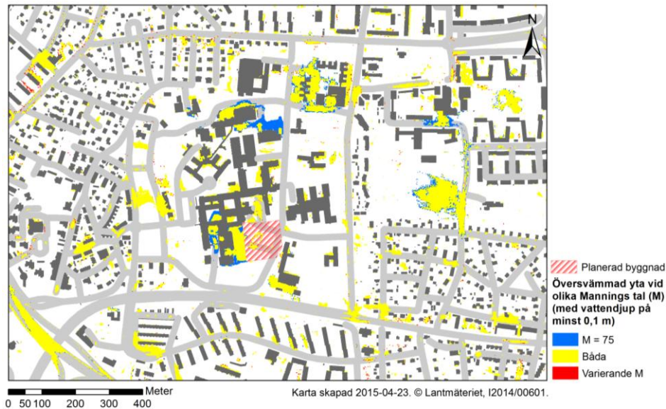
Figur 26. Översvämmad yta (minst 0,1 m) vid både varierande värden på M samt med ett konstant värde på 75. De områden som endast översvämmas vid varierande M respektive M = 75 finns också utmarkerade.
