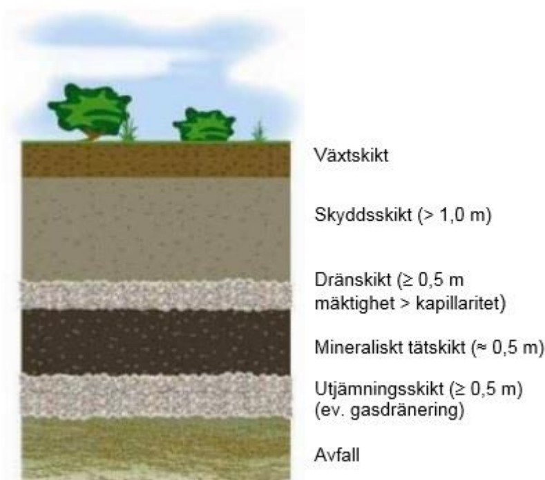
Figur 7: En deponitäckningskonstruktion i genomskärning.
