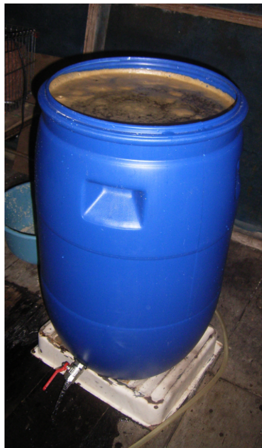
Figur 16. Prototyp av mindre sandfilter för vattenrening på hushållsnivå.
