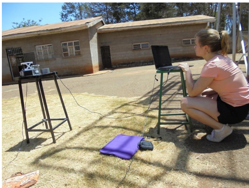
Figur 11. Uppställningen av reaktorn utomhus. Reaktorn exponeras för solljus medan mjukvaran i datorn erhåller signalen under pågående experiment. Foto: Sanna Rutqvist.
