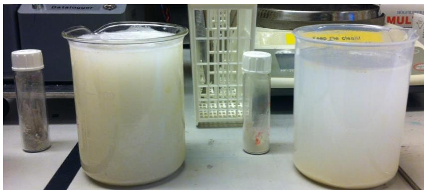
Figur 19. I den vänstra bägaren tillsattes Moringaprotein, medan den högra bägaren förblev orörd. Foto: Sanna Rutqvist.
