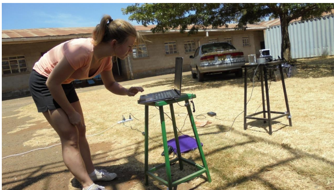
Figur 24. Installationen klar. Reaktorn stod i solen (till höger i bild) och mjukvaran i datorn registrerade den fotokatalytiska nedbrytningen. Foto: Sanna Rutqvist.
