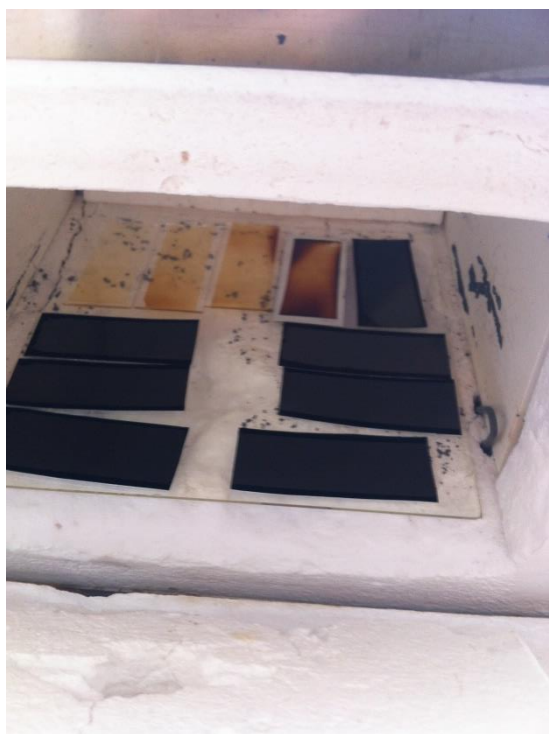
Figur 13. Färdiga små prover som togs ut ur ugnen. Delvis lyckade prover med titandioxidfilmer som fäste till proverna. Foto: Sanna Rutqvist
