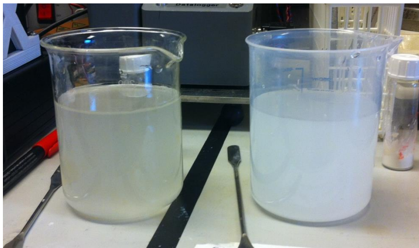
Figur 18. Suspensionerna innan tillsats av Moringaprotein. Bägaren till vänster innehöll Bentonit och bägaren till höger innehöll Kaolinit. Foto: Sanna Rutqvist.
