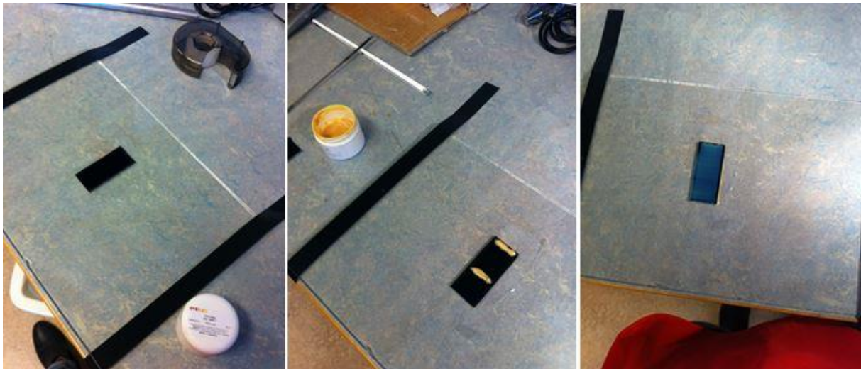
Figur 9. Schematisk bild över den genomförda provprepareringen. Provet placerades på glasskivan (vänster). Därefter applicerades titandioxidpastan (mitten). Metallstaven drogs över provet och en tunn film erhöles (höger). Foto: Sanna Rutqvist.
