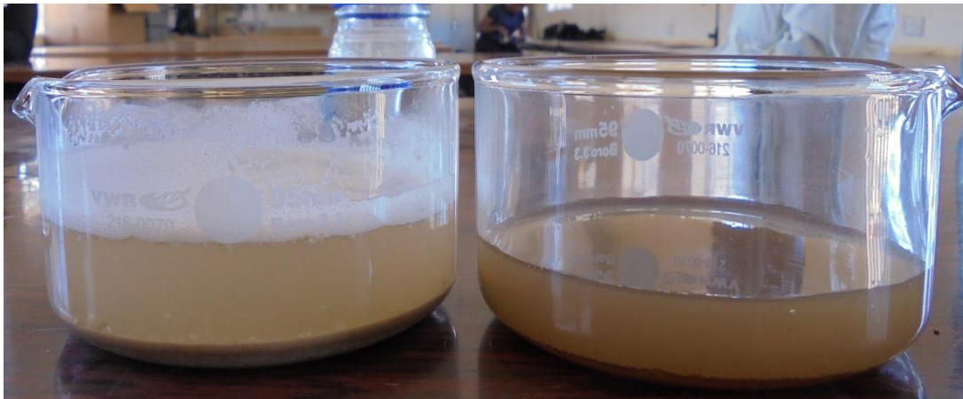
Figur 33. Fotografi efter 30 minuter. På botten i bägarna syntes den mängd partiklar som sedimenterat vid denna tidpunkt. Foto: Sanna Rutqvist.
