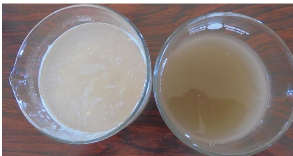
Figur 35. Skillnaden i turbiditet då behandlingen avslutades, visat uppifrån. Foto: Sanna Rutqvist.
