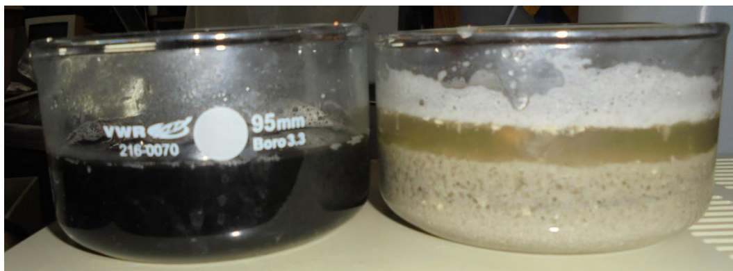
Figur 40. Innehållet i den högra bägaren började sedimentera och turbiditeten förändrades. Foto: Sanna Rutqvist.
