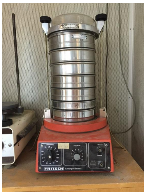
Figur 22. Staplade siktråg, försedda med uppsamlingstråg samt lock och isatta i skakmaskinen. (Foto: M. Mellander)
