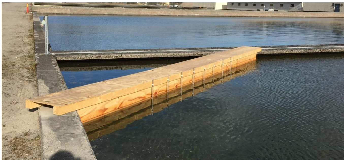
Figur 19. En av de två spängerna, med monterade nivå-rör, som användes i studien. (Foto: M. Mellander)
