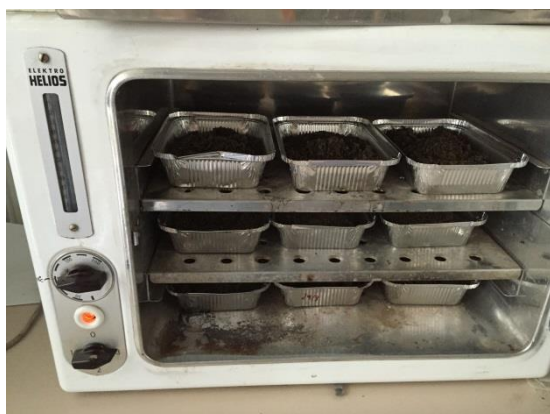
Figur 21. Sandprover överförda i aluminiumfolieformar och inställda i torkugnen. (Foto: M. Mellander)
