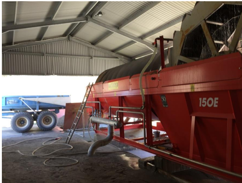
Figur 14. I förgrunden ses sandtvätten. I bakgrunden ses traktorkärran som precis tippat av sand ned i förvaringsutrymmet. (Foto: M. Mellander)
