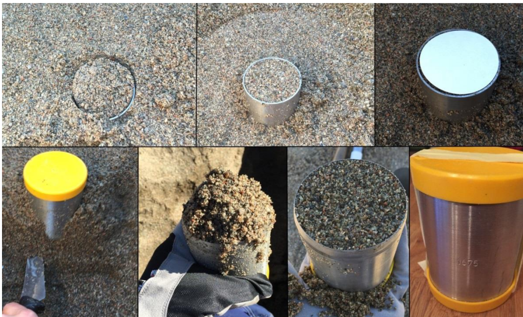
Figur 20. Förfarande vid cylinderprovtagning, där första steget visas uppe till vänster och sista steget visas nere till höger. (Foto: M. Mellander)
