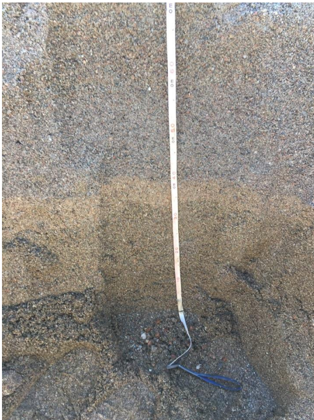
Figur 75. Provgrop i filter 14, plats 1 där tydliga skiktningar kunde urskiljas. (Foto: M. Mellander)
