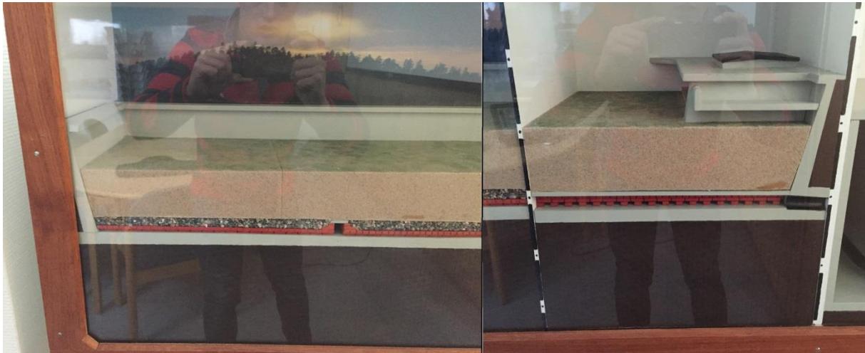
Figur 9. Miniaturmodell av sandfiltren. Till vänster ses en tvärsektion av ett filter, där en tvärsektion av en kanal kan ses. Till höger ses en längdsektion i kanalen, där även utloppet ses i filtrets underdel. I den högra delen av bilden visas även inloppet som en ränna i filtrets ovandel. (Foto: M. Mellander)
