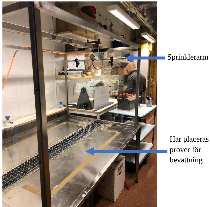
Figur 26. Regnsimulator. På botten placeras de prover som ska bevattnas. Vid bevattning rör sig sprinklerarmen fram och tillbaka under så lång tid som programmeras. Foto: Örjan Berglund.
