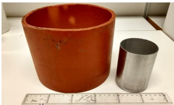
Figur 15. PVC-rör (vänster) och stålcyllinder (höger). PVC-röret är 15 cm högt och 183 mm i inre diameter. Stålcyllindern är 100 mm hög, 72 mm i inre diameter och 75 mm i yttre diameter.
