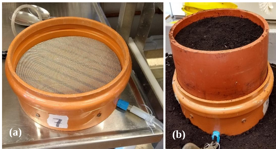
Figur 25. (a) Underrede till lysimeter för regnsimulering och (b) lysimeter förberedd för regnsimulering. Jordytan är 2 cm nedanför PVC-rörets överkant.
