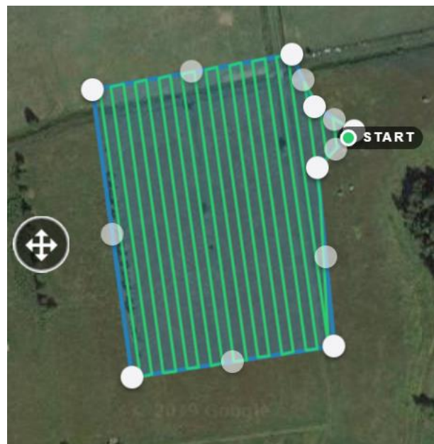
Figur 51. De blåa linjerna ramar in området som valts för fotografering. De gröna linjerna visa drönarens flygrutt. Rutten varierade med val av flyghöjd och procent överlappning.
