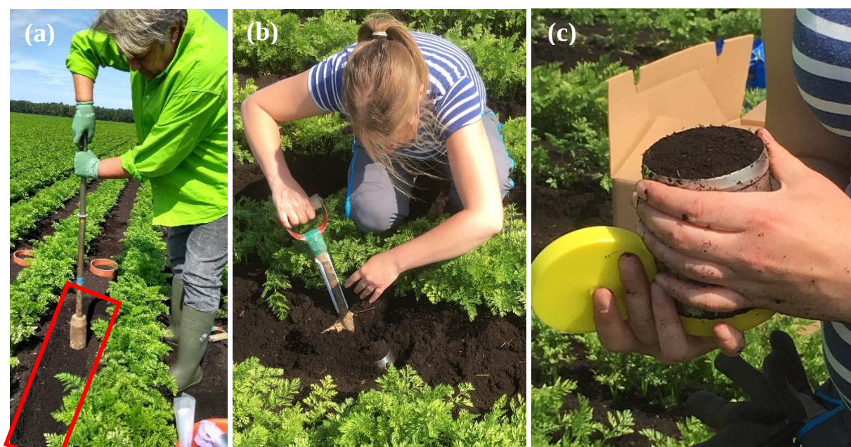
Figur 16. (a) Stålcylinder slås ned med specialdesignad slägga. Röd ruta markerar var raden stålcylindrar är placerade. (b) Stålcylinder grävs upp. (c) Stålcylinder förses med filterpapper och lock (c).
