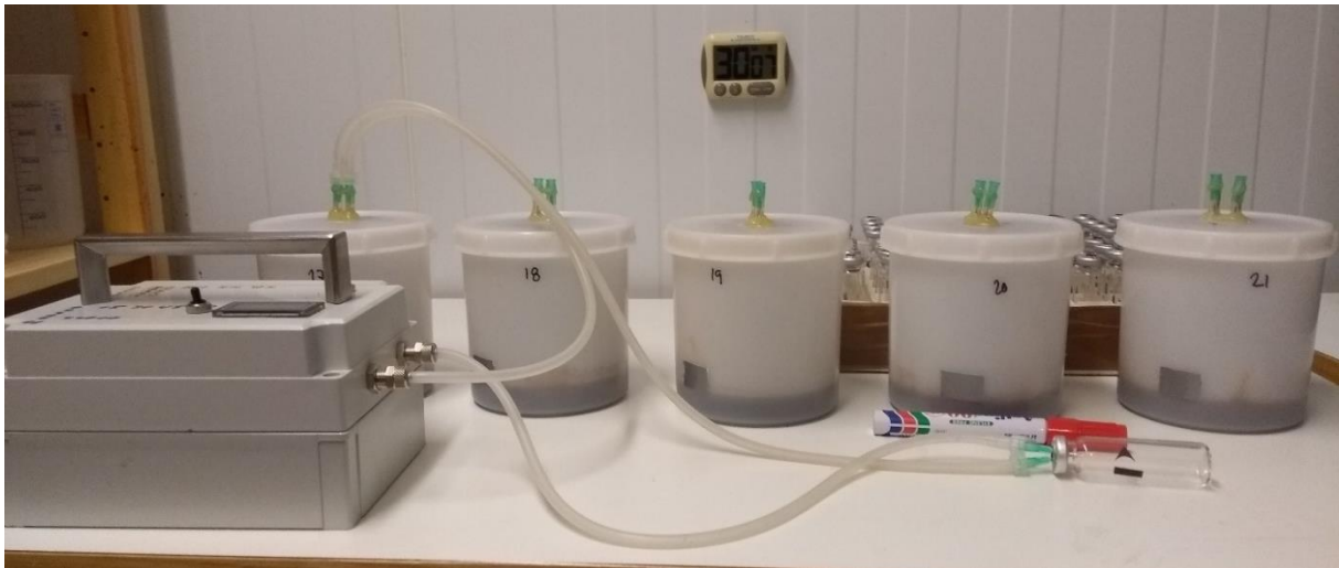
Figur 22. Burkar uppställda för mätning av \text{N}_2\text{O} och \text{CH}_4 . Pump är kopplad till burk som är kopplad till glasvial som sedan går tillbaka till pumpen igen. Figur visar pump använd för mätningar av \text{N}_2\text{O} och \text{CH}_4 . Slangarna är 4 mm i diameter och har total längd på 1,3 m.
