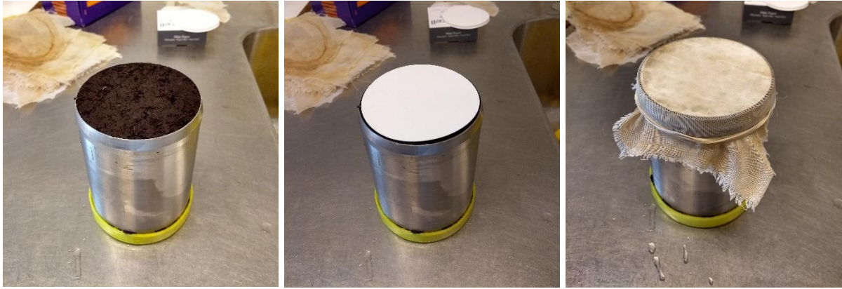
Figur 18. Stålcylindrarna förbereddes för labbförsök. Ett filterpapper lades på undersidan, därefter fästes ett finmaskigt nät med gummisnodd. I figuren är stålcylinders undersida uppåt.
