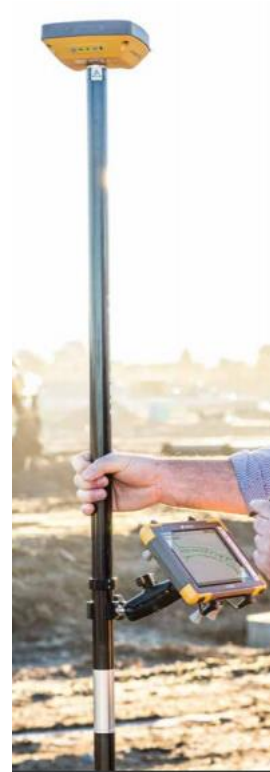
Figur 48. GPS Topcon FC-5000 och handdator på stativ (Topcon 2016).
