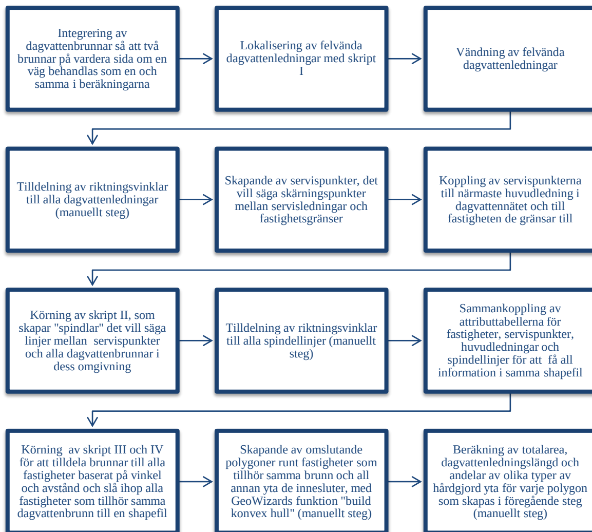
Figur 2, flödesschema över algoritmen för den objektorienterade beräkningsmetoden av delavrinningsområden
