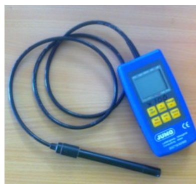
Figur 19. Konduktivitetsmätare. Foto: Liselott Karlsson
