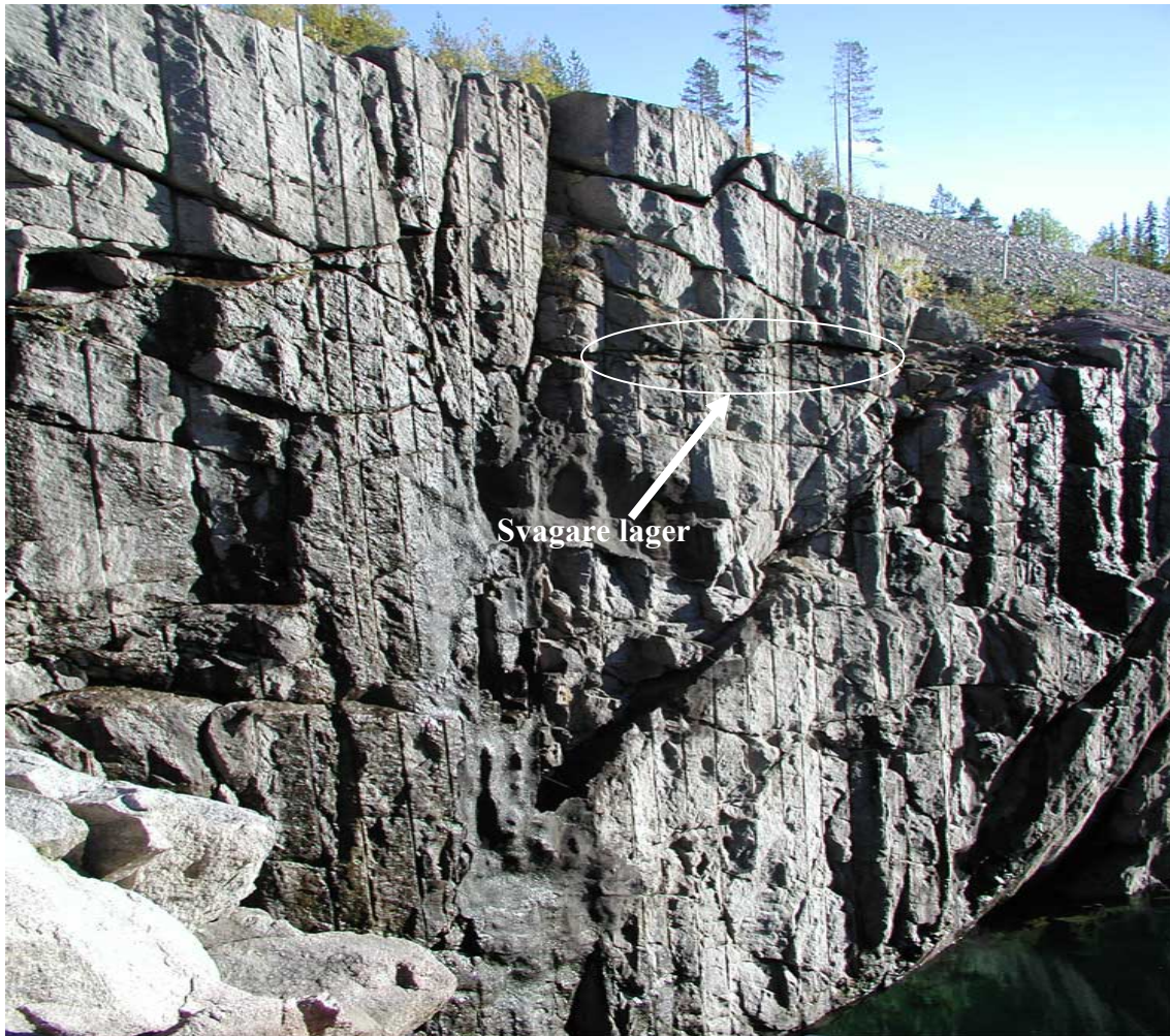
Figur 6.12 Ett exempel på ett svagare lager i bergmassan i Seitevares kanal.
