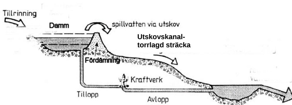
Figur 1.1 Principskiss över en vattenkraftsdamm med utskovskanal (Bergström, 1999).
