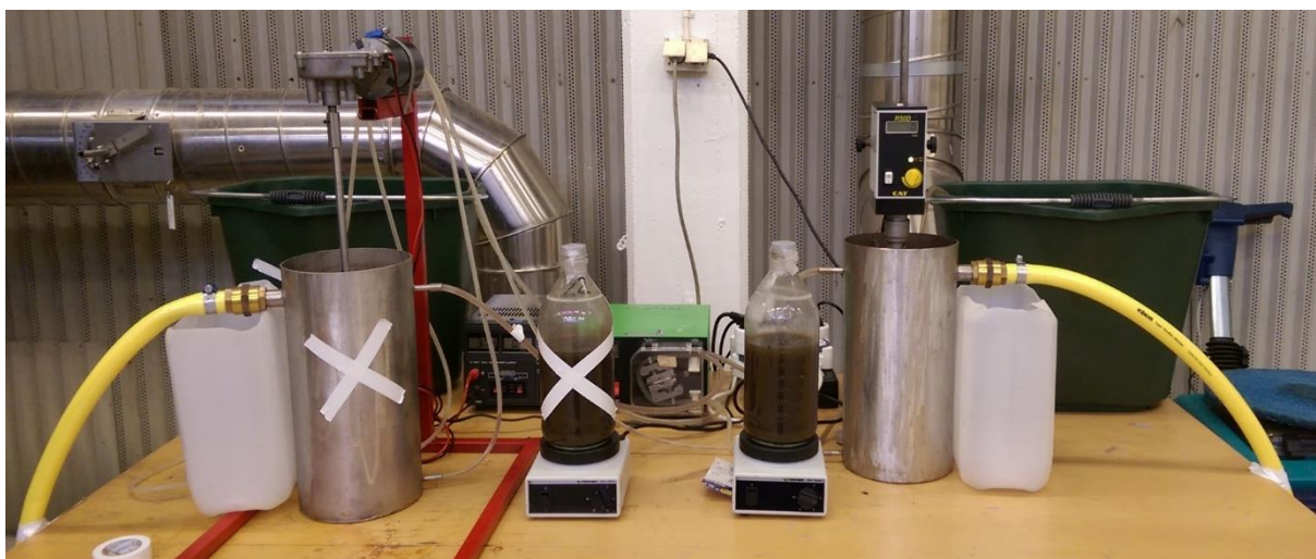
Figur 6 Pilotförsökets uppställning med försöksreaktor, referensreaktor och sidostromshydrolyser.
