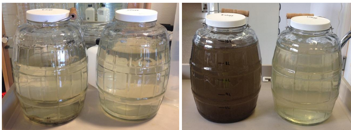
Figur 17. Till vänster: inlopps- och utloppsvatten för den måttligt regniga provperioden nr 6. Till höger: inlopps- och utloppsvatten för provperiod 7 där det förekom mycket nederbörd. Foto: Jonathan Arnlund.
