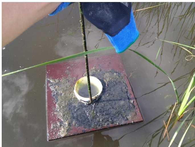
Figur 19. Upptag av sedimentfälla nr 7 den 26/5 där sedimenten var fläckvist fördelade på plattan. Foto: Jonathan Arnlund.
