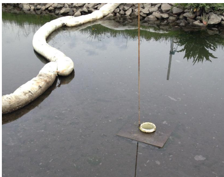
Figur 10. Sedimentfälla innan oljerensen vid fördiket till Kungsängsdammen. Vid fototillfället var vattenståndet mycket lågt och därmed låg skivan ovanför vattenytan. Foto: Jonathan Arnlund.
