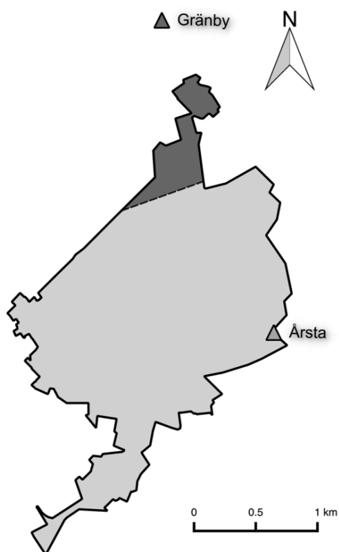
Figur 15. Viktning av Uppsala Vattens nederbördsstationer (trianglar) enligt Thiessen polygonmetod resulterade i 0,075 för Gränby (mörkgrå) och 0,925 för Årsta (ljusgrå) baserat på areorna av Voronoipolygonerna i förhållande till avrinningsområdets totala area. © Copyright Uppsala kommun. Kommunens upphovsrätt omfattar även licenstagarens bearbetning av materialet. Kopiering, digitalisering eller avritning av materialet är inte tillåten.
