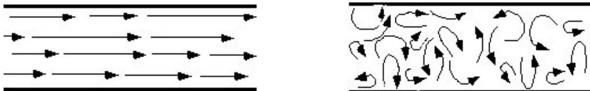
Figur 10 Skillnaden mellan laminärt (till vänster) och turbulentflöde (till höger). Vid turbulent flöde har vätskan en större hastighet och partiklarna kommer att blandas i vertikalled, något som inte sker vid laminärtflöde
