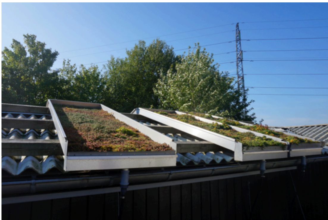
Figur 6 Takbehållare i norrläge av modellerna; XMS 2-27°, XSÖG 5-14° och XSÖG-Grodan (från vänster till höger) (Foto: Jenny Andersson, 2014).
