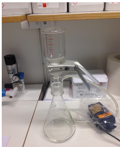
Figur 13 Laborationsuppställning för TSS-analys (Foto: Jenny Andersson, 2014).
