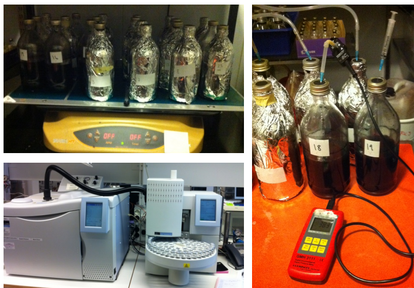
Figur 6. Reactorer på skabbord i 37°C och gaskromatograf som användes för metanhaltanalys till vänster. Till höger mättes tryck och gasprov togs.
