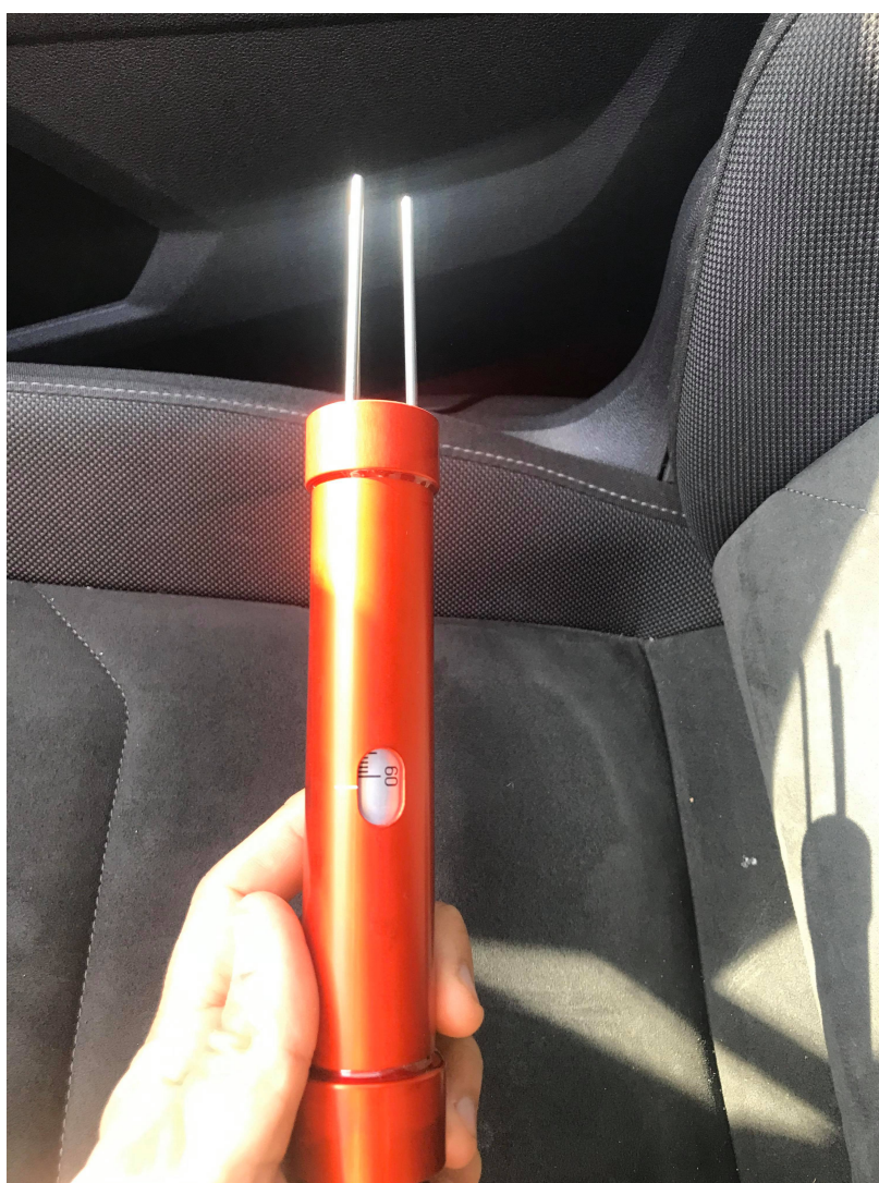
Figur 15: Mätstickan som användes vid kompakteringsmätningarna. Bild: Christian Cerna.
