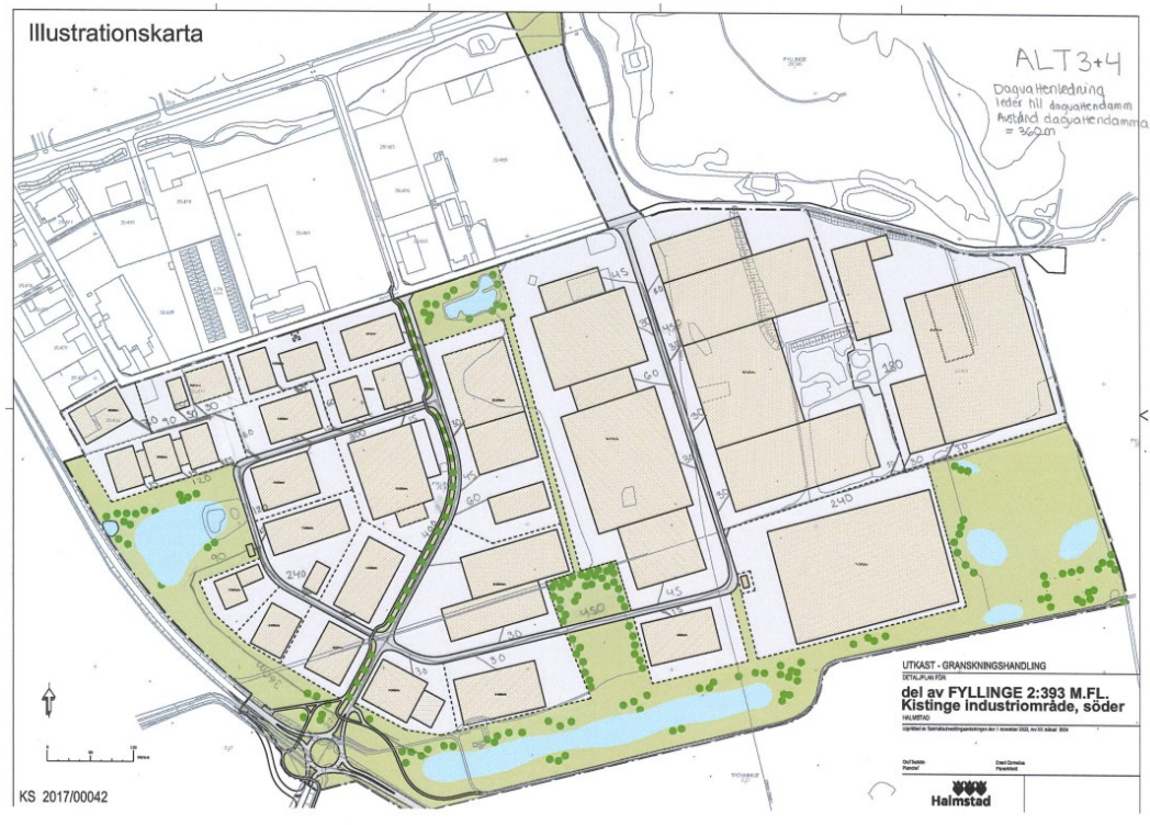
Figur A9: Uppskattade ledningsdragningar för alternativ 3 och 4, de storskaliga systemen. Ledningarna antogs vara från dammen för tekniskt vatten tillbaka till fastigheterna.
