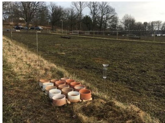
Figur 10: Cylindrarnas placering intill hagen med regnmätaren intill. Cylindrarna är placerade på ett avstånd från hagen så att hästarna inte når.
