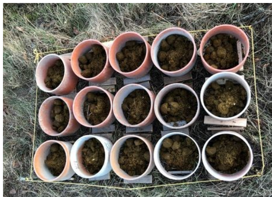
Figur 9: Cylindrarna dag ett när gödsel precis har placerats ut i dem. Gräs har rivits undan under gödselhögarna för att efterlikna hagens förhållanden.
