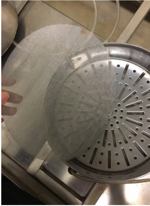
Figur 12: Nät i botten på cylindrarna för att förhindra att gödsel rinner iväg.
