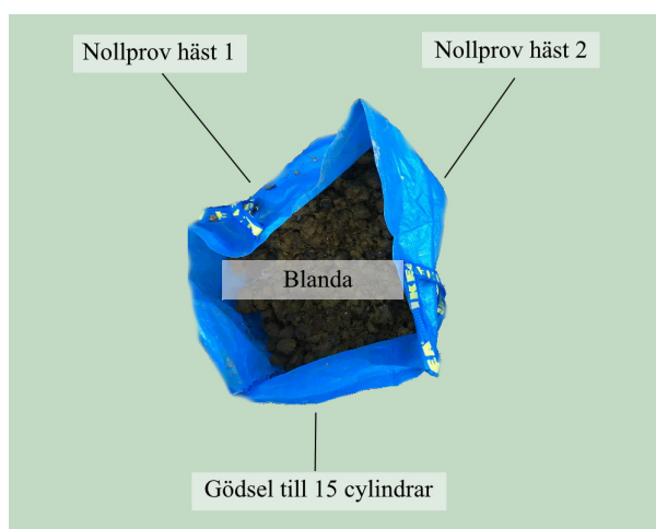
Figur 8: Metod för provtagning av nollprov och gödsel till cylindrarna. Nollproven togs från respektive häst, för att sedan blandas och placeras i cylindrarna.
