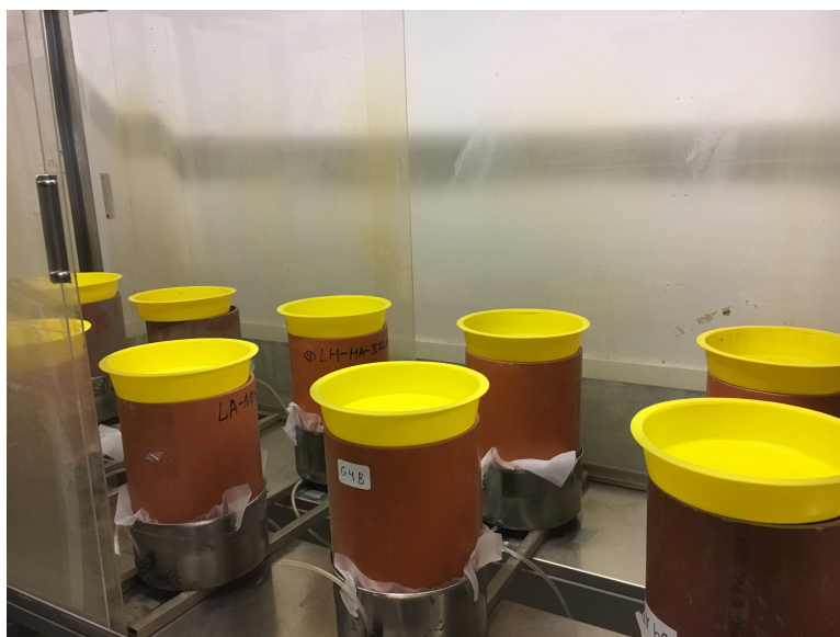
Figur 14: Cylindrarna uppställda med gula fat som fångar in vattnet och sedan vägs för kalibrering.
