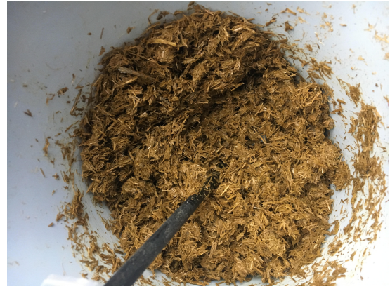
Figur 7: Gödsel homogeniserades och två stycken prover togs från olika delar av hinken för att få ett representativt prov från 7 dagar.
