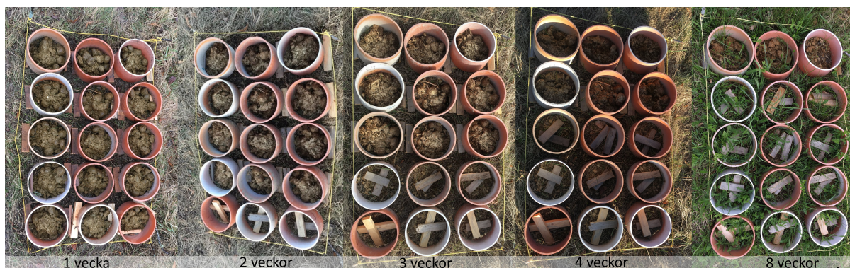
Figur 11: Bild före provtagning av cylindrarna (3 per vecka) i fält för varje vecka. De tomma cylindrarna lämnades kvar efter provtagning.
