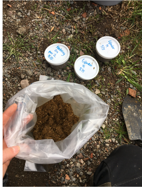
Figur 5: Bild på provtagningspåsen och laboratoriumets provburkar.
