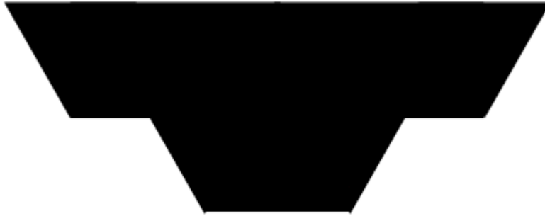
Figur 9: Tvärsektionen för en två-steps design av en damm
