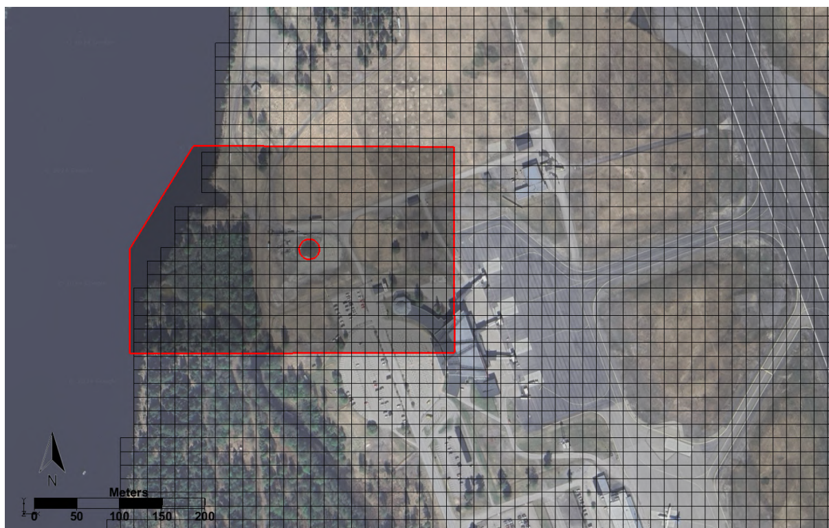
Figur 4.9: Område som användes för att undersöka flödes hastigheten vid den gamla BÖP för att bestämma en rimlig uttagshastighet på brunnar. Området sträcker sig i djupled genom samtliga lager i modellen.
