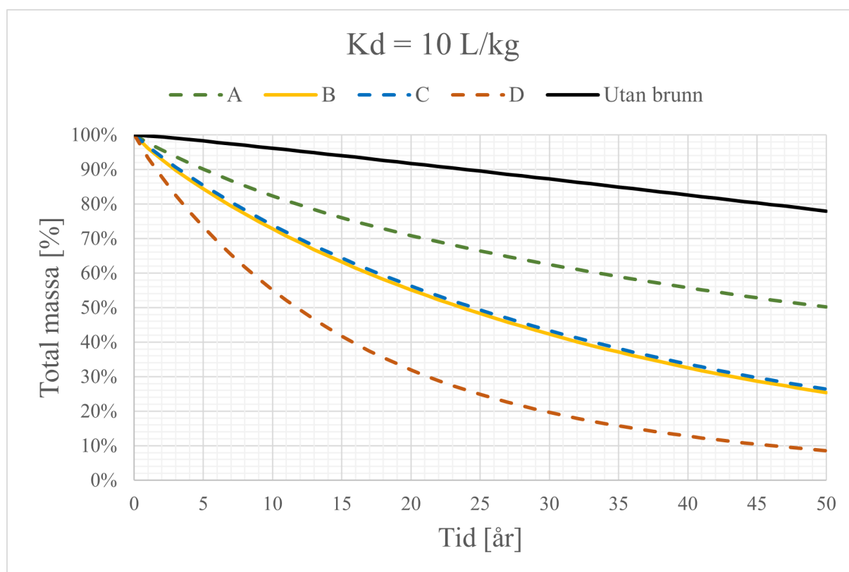
Figur 5.32: Total massa PFAS [%] i modellerna A, B, C och D över en tidsperiod på 50 år för K_d = 10 \text{ L/kg} .
