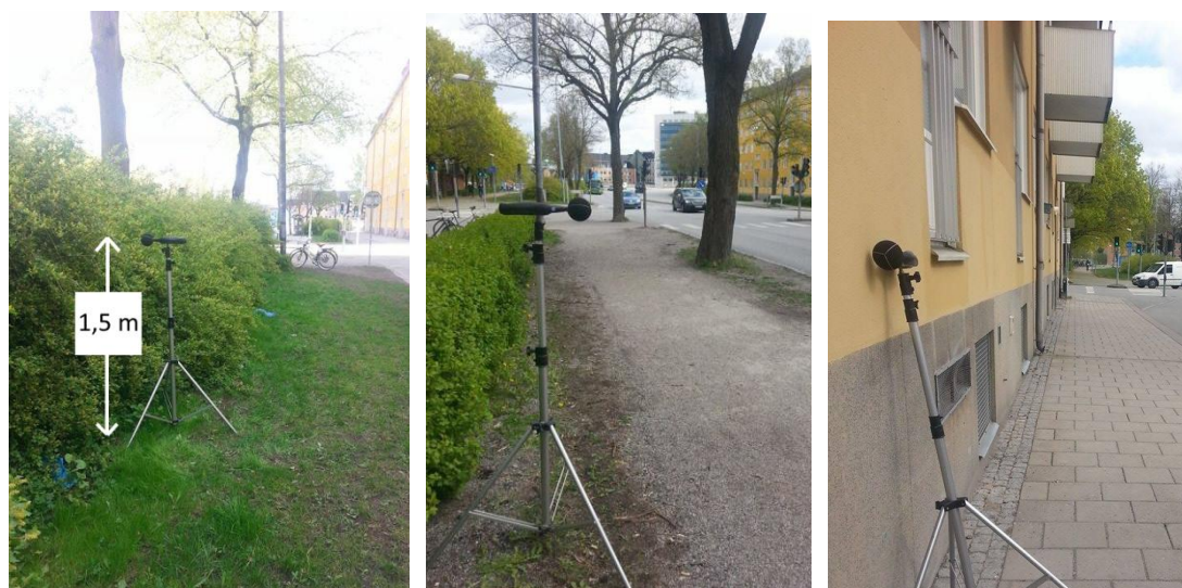
Figur 24. Mikrofonplaceringar vid mätplats 1, 2 respektive 4. Mikrofonplaceringen vid mätplats 3 var snarlik den i mätplats 4. Höjden för mikrofonen var 1,5 m i alla fall. Bild: Elin Claesson
