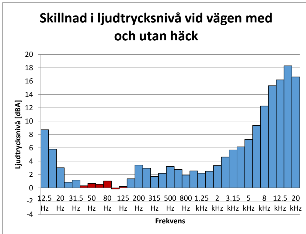
Figur 13. Skillnad i frekvensfördelning av det totala ljudet under hela mätperioden mellan mätplats 1 och 2. De ljusblå staplarna betyder att mätplatsen med häck hade signifikant lägre värden än mätplatsen utan häck enligt Wilcoxon rank sum test och de röda betyder att ingen signifikant skillnad råder.
