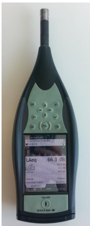
Figur 8. Brüel & Kjaer ljudnivåanalysator typ 2250 som användes vid mätningen. Bild: Elin Claesson
