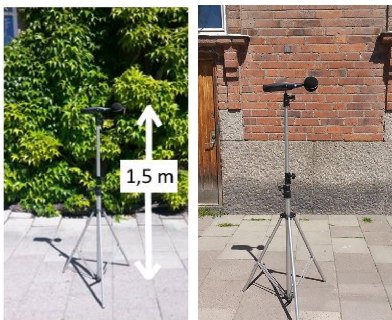
Figur 27. Mikrofonplacering för trottoarmätning på Norr Mälarstrand 90. Mikrofonen var placerad 1,5 m ovan mark vid båda trottoarmätningarna. Bild: Elin Claesson
