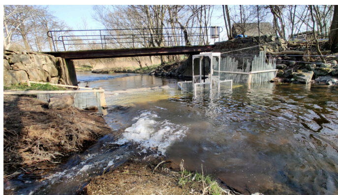
Figur 11. En fiskräknare i Tommarpsån omgiven av vertikala galler och flytgaller (TiVA 2023b).
