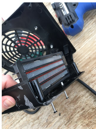
Figur 9: Ett fotografi som visar säkerhetsåtgärden för kupévärmarna. Två stycken skruvar fästes på var sida av kupévärmarna för att hindra dem från att trilla trilla ned i vattnet.
