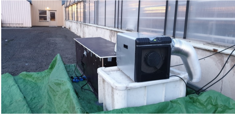
Figur 10: Ett fotografi som visar systemet utomhus. Avfuktaren och kistan var placerade ovanpå en grön presenning, som senare förslöts kring systemet.
