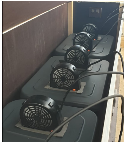
Figur 7: Ett fotografi som visar kupévärmarna placerade i locket på lådorna med utloppen riktade rakt nedåt. I bilden ses inte de cirkulära utloppen.
