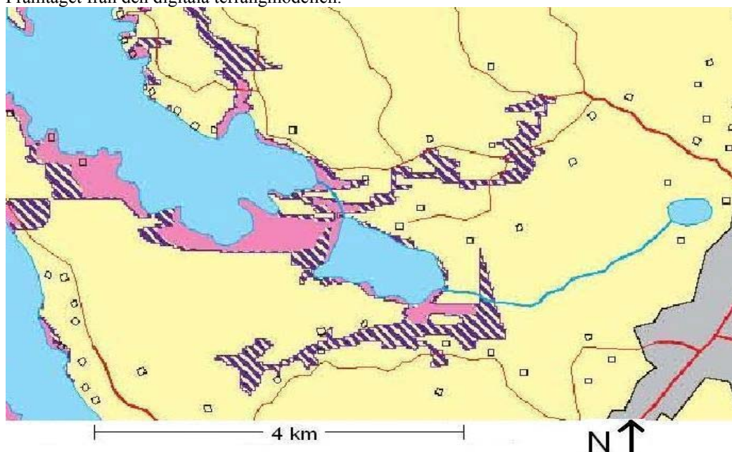
Figur 25. Översvämningskartering vid Tärnsjö. De rosa områdena motsvarar 100-årsflödet 1930 m 3 /s och de randiga områdena motsvarar ett beräknat högsta flöde, 3692 m 3 /s. Bilden är tagen från Räddningsverkets hemsida, ( www.raddningsverket.se ).
