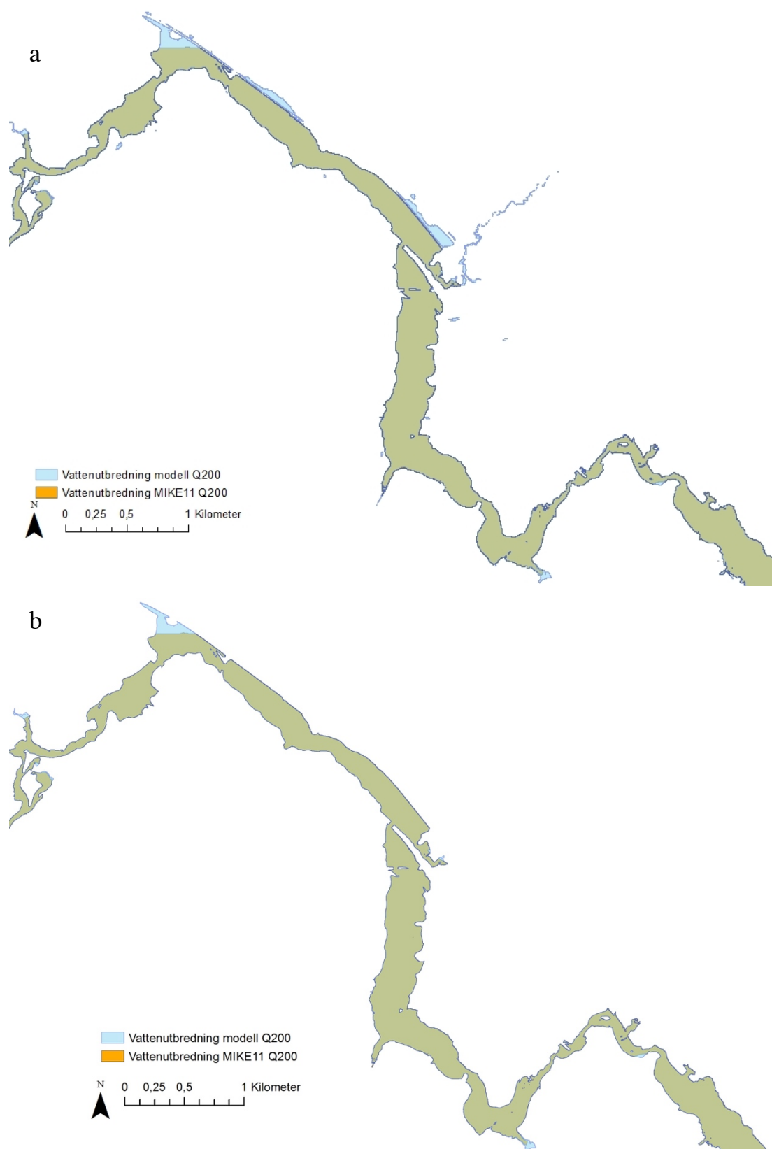
Figur 44. Vattenutbredningsskikt för 200-årsflöde i Suseån genererade med SÖK-modellen (benämns modell i legenden) respektive i MIKE 11. Detaljbild över detaljområde 1 i Figur 42. I del a har samtliga öpolygoner behållits och i b har samtliga sorterats bort. Vattenutbredningsskikt genererade med modellen har gjorts transparenta för att underlätta illustrering av skillnader.
