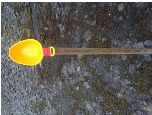
Figur 8. Anordning för att samla upp vatten vid utlopp från biobädd. Foto: Amanda Haglind.
