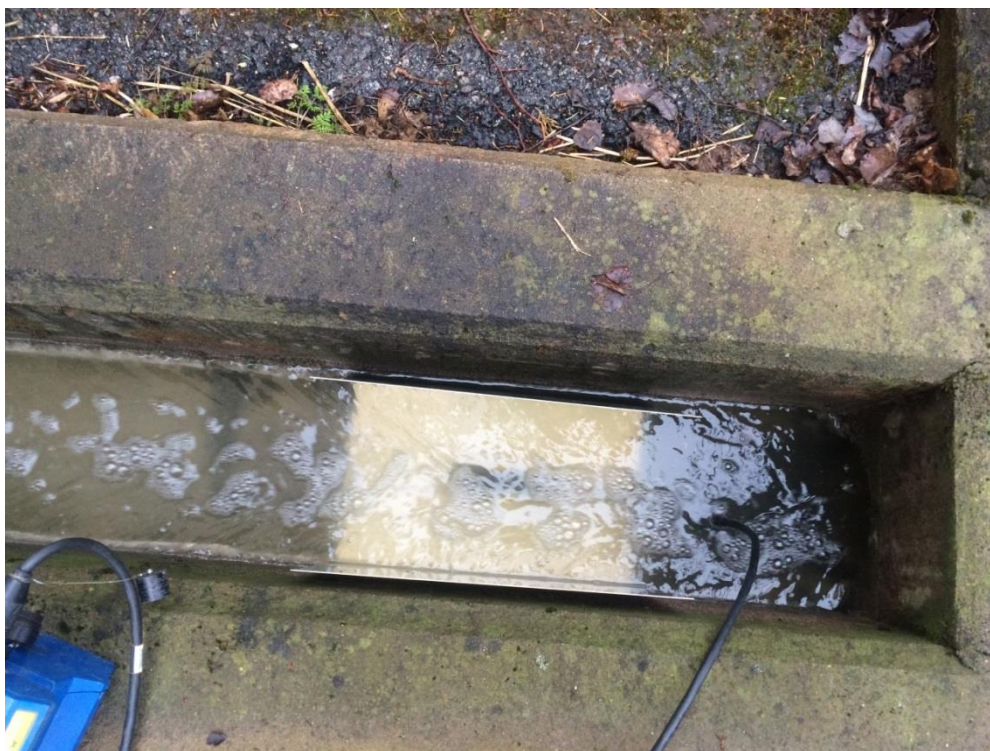
Figur 7. Flödesmätning på utgående vatten från biobädd. På bilden visas rännan för utgående vatten från biobädden, plåten som håller fast flödesmätaren och fastsatt på plåten anas flödesmätaren. I vänstra hörnet ses delar av loggern. Foto: Amanda Haglind.
