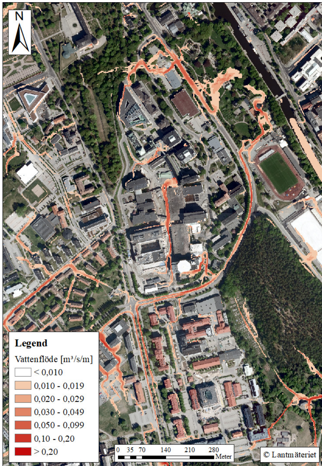
Figur 15: Maxvattenflödet från körning med blockregn (Blk1). Återkomsttid: 100 år. Varaktighet: 30 minuter. Bakgrundskarta: GSD-Ortofot RGB 0,25 m (2020), © Lantmäteriet.
