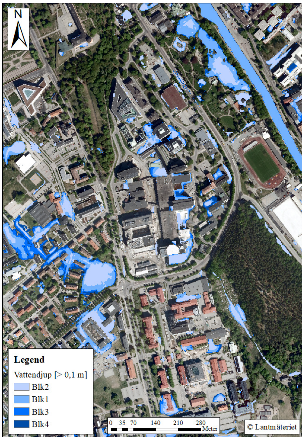
Figur 27: Vattendjupet vid slutet av fyra timmars simulering från körningar med olika varaktigheter. Resultat från Blk2 (10 minuters varaktighet), Blk1 (30 minuter), Blk3 (60 minuter) och Blk4 (150 minuter) presenteras i figuren. Vattendjup större än 0,1 meter visas. Bakgrundskarta: GSD-Ortofoto RGB 0,25 m (2020), © Lantmäteriet.
