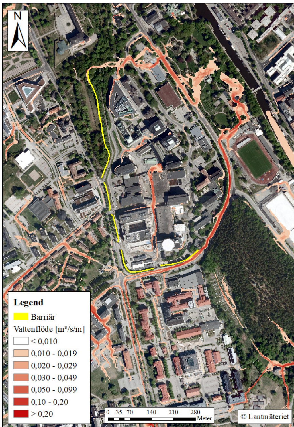
Figur 19: Maxvattenflödet från körning med blockregn och barriär (Bar1). Återkomsttid: 100 år. Varaktighet: 30 minuter. Bakgrundskarta: GSD-Ortofot RGB 0,25 m (2020), © Lantmäteriet.
