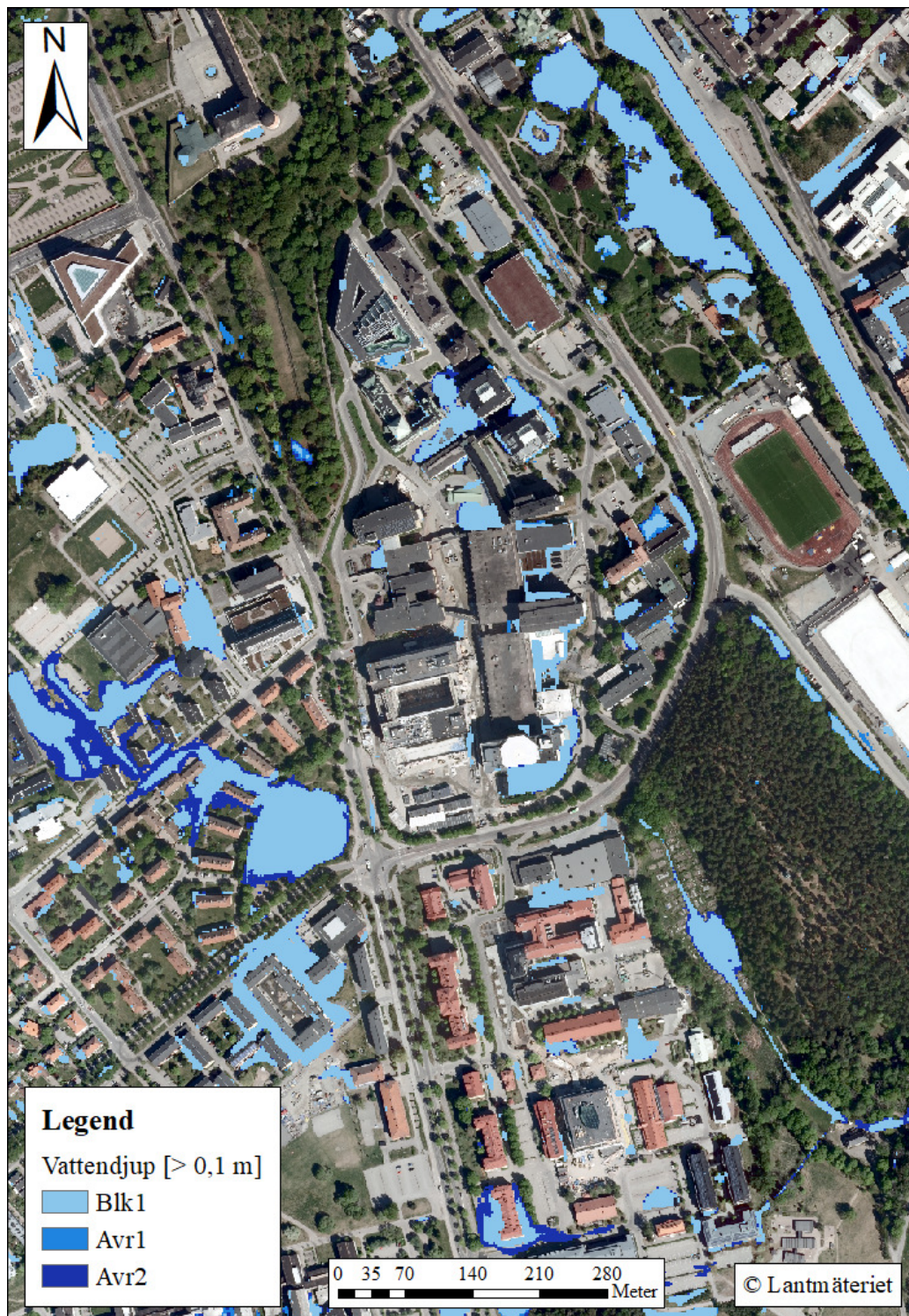
Figur 30: Vattendjupet vid simuleringens slut från körning med Blk1, Avr1 samt Avr2. Vattendjup större än 0,1 meter visas. Återkomsttid: 100-år. Varaktighet: 30 minuter. Bakgrundskarta: GSD-Ortofot RGB 0,25 m (2020), © Lantmäteriet.
