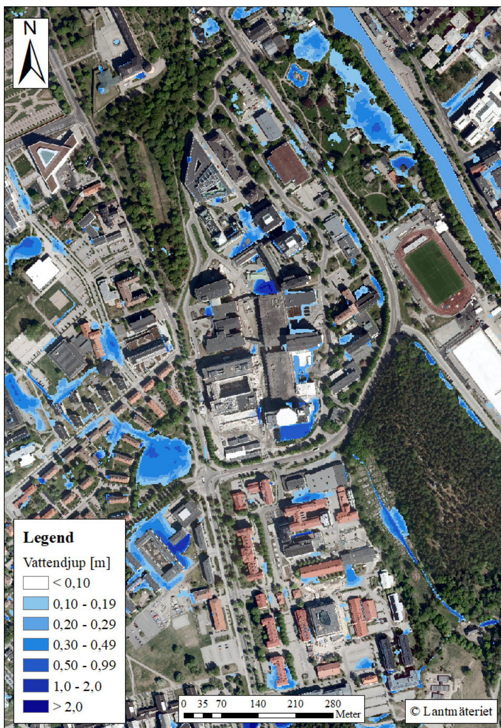
Figur 14: Vattendjupet vid simuleringens slut från körning med blockregn (Blk1). Återkomsttid: 100 år. Varaktighet: 30 minuter. Bakgrundskarta: GSD-Ortofoto RGB 0,25 m (2020), © Lantmäteriet.
