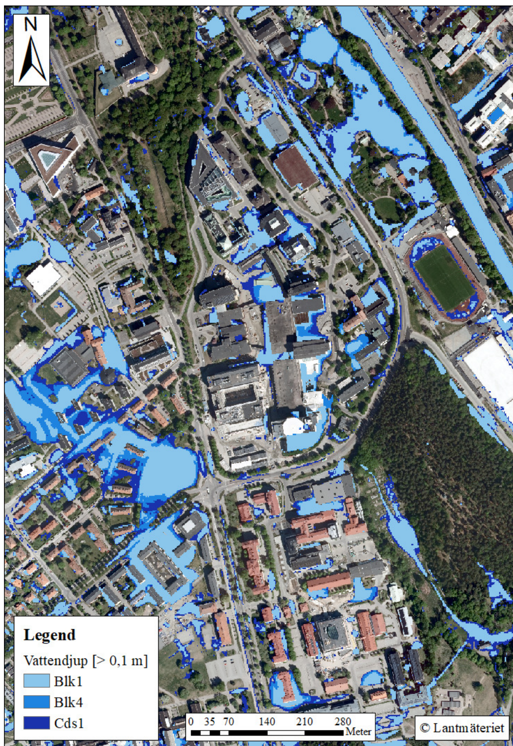
Figur 25: Maxvattendjupet från körningar med Blk1, Blk4 och Cds1. Vattendjup större än 0,1 meter visas. Bakgrundskarta: GSD-Ortofoto RGB 0,25 m (2020), © Lantmäteriet.
