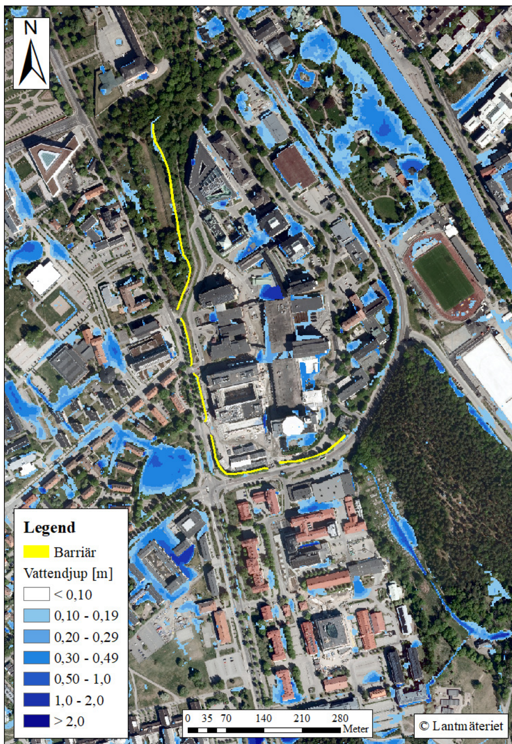
Figur 18: Maxvattendjupet från körning med blockregn och barriär (Bar1). Återkomsttid: 100 år. Varaktighet: 30 minuter. Bakgrundskarta: GSD-Ortofot RGB 0,25 m (2020), © Lantmäteriet.
